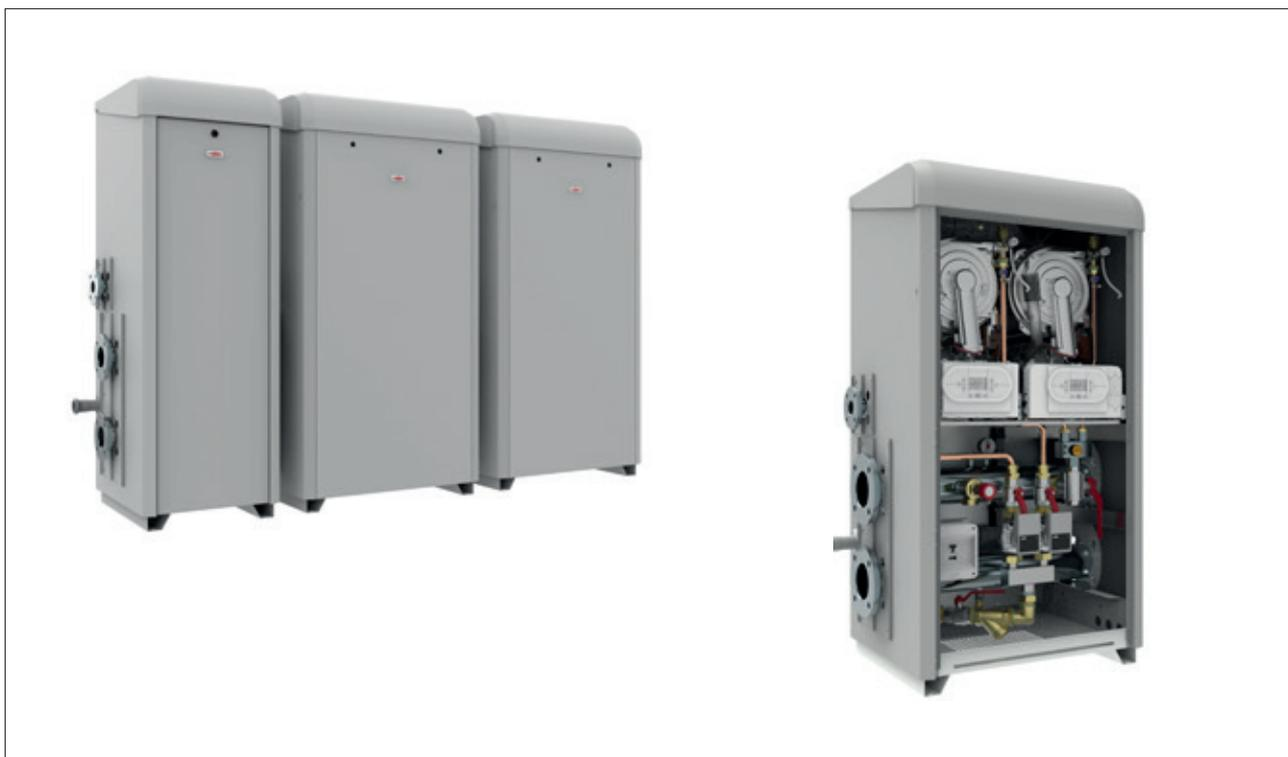
Ассортимент тепловых генераторов High Power серии MODULO для наружной установки доступен в следующих трех мощностях: 50, 60, 75, 100 и 120 кВт, все они выполнены в Radiant, с теплообменником из нержавеющей стали  $\varnothing$  28 мм, чтобы удовлетворить потребности в мощности. увеличение запросов в крайне ограниченном пространстве. Котлы предназначены для индивидуальной или каскадной установки, независимой друг от друга.
